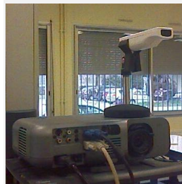
Wiimote placé sur le vidéoprojecteur.
